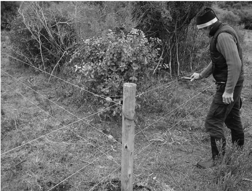
Utilización de voltímetro para controlar el correcto funcionamiento del sistema (Santiago, en el predio de Esther).
