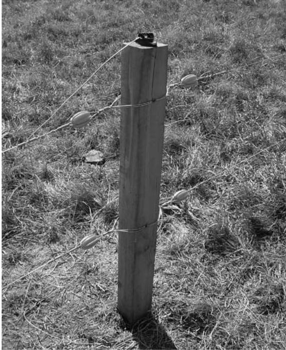
Aisladores de fabricación industrial robustos en un poste principal; se observa un “puente” utilizando un aislador de pique para darle continuidad a la corriente (predio de Nelly).
