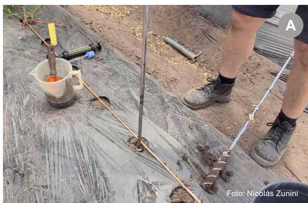
Figura 5 - Monitoreo de la humedad de suelo con tensiómetro a 15 cm de profundidad en cultivo de tomate sobre suelo franco limoso.
