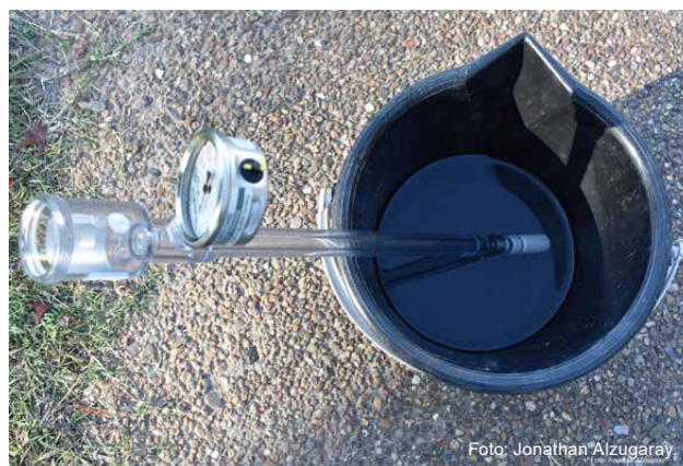
Figura 2 - Preparación de tensiómetro para la instalación.
