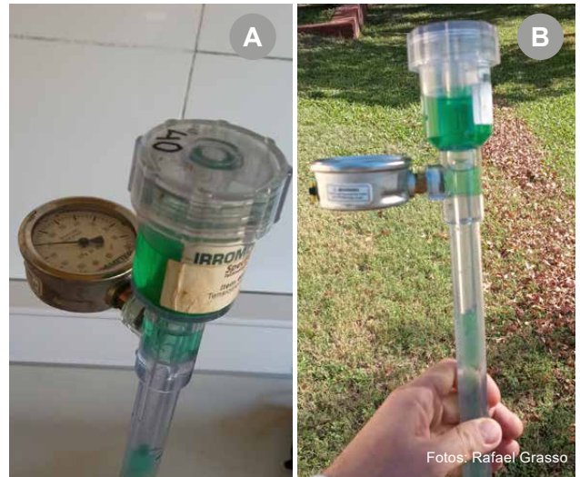
Figura 8 - A) aumento de la presión en el manómetro por burbuja de aire; B) burbuja de aire en el cuerpo del tensiómetro.
