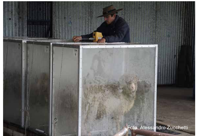
Figura 3 - Determinación de emisión de metano en breves períodos de tiempo.
