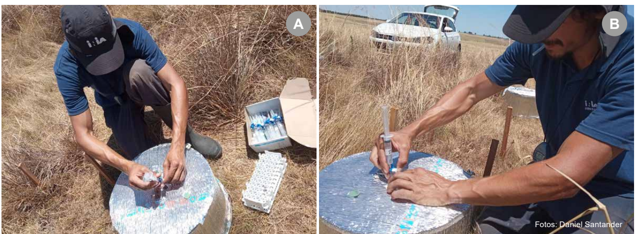
Figura 3 - Cierre de cámaras y toma de muestras de N_2O en campo natural tras aplicación de orina bovina.
