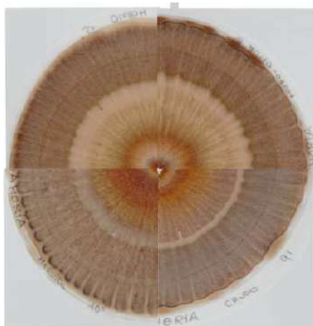
Figura 5. Cromatogramas de zanahorias con diferentes cocciones: horno (arriba a la izquierda); hervido (arriba a la derecha); micro-ondas (abajo a la izquierda); crudo (abajo a la derecha).
